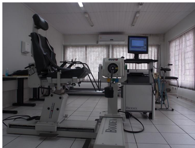
Figura 2 - Dinamômetro isocinético Biodex™ modelo Multi Joint System 4 Pro, Shirley, NY, Estados Unidos.
